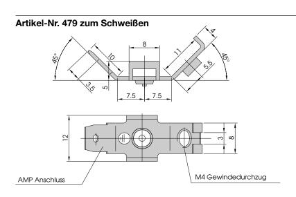
Werkstoff: Stahlblech verkupfert / Steel cu-plated
