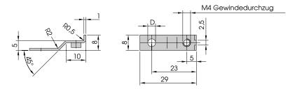
Werkstoff: Stahlblech verkupfert / Steel cu-plated
